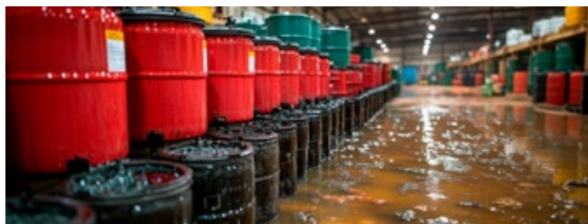
Gefahrstoffgebinde können bei Starkregen beschädigt werden, aufschwimmen oder unkontrolliert verdriften.
