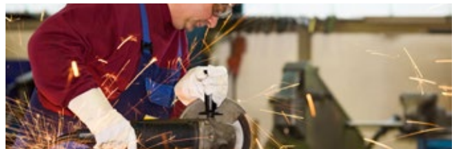
Wer Schutzhaube und Einstellwinkel klug wählt, lenkt die Funken gezielt in eine sichere Zone statt irgendwohin.
