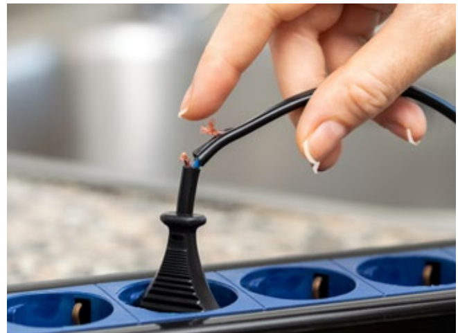
Defekte Kabel sind kein Bagateltschaden.
