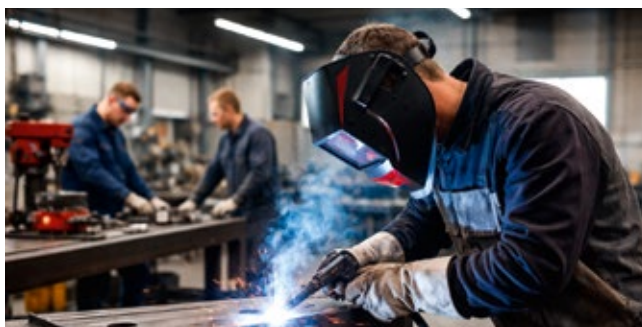
Alle Personen im Umfeld müssen unterwiesen werden, denn z. B. UV-Strahlung gefährdet nicht nur den Schweißer selbst.
