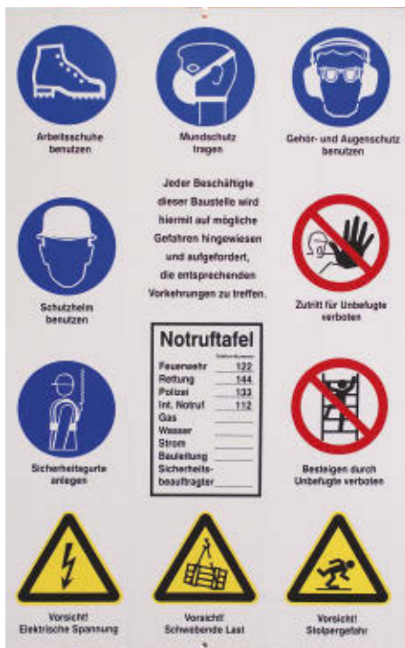
Gefahrenzeichen warnen vor Baustellenunfällen.
