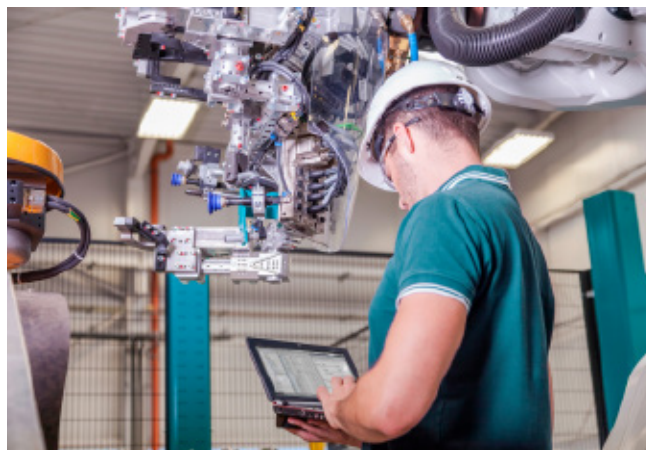
Bei Inbetriebnahmen sind trennende und andere Schutzeinrichtungen oft (noch) nicht aktiv.
